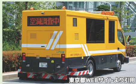
道路下の状態を調査・点検する「空洞探査車」
